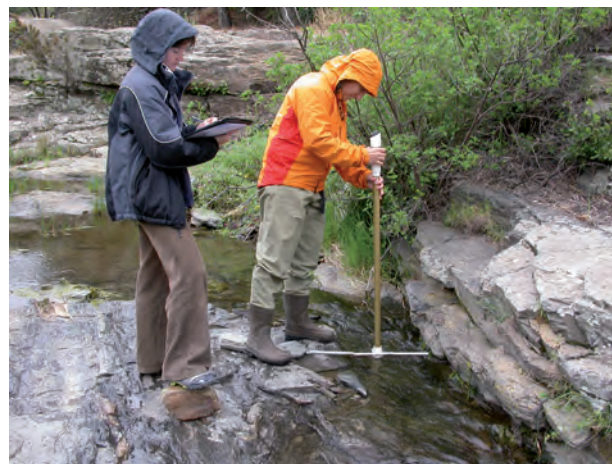
Procés de determinació del cabal pel mètode velocitat-àrea a la riera de Rubiés (Port de la Selva, l'Alt Empordà). Maig de 2007. [Foto: Jesús Ortiz-CERM]
