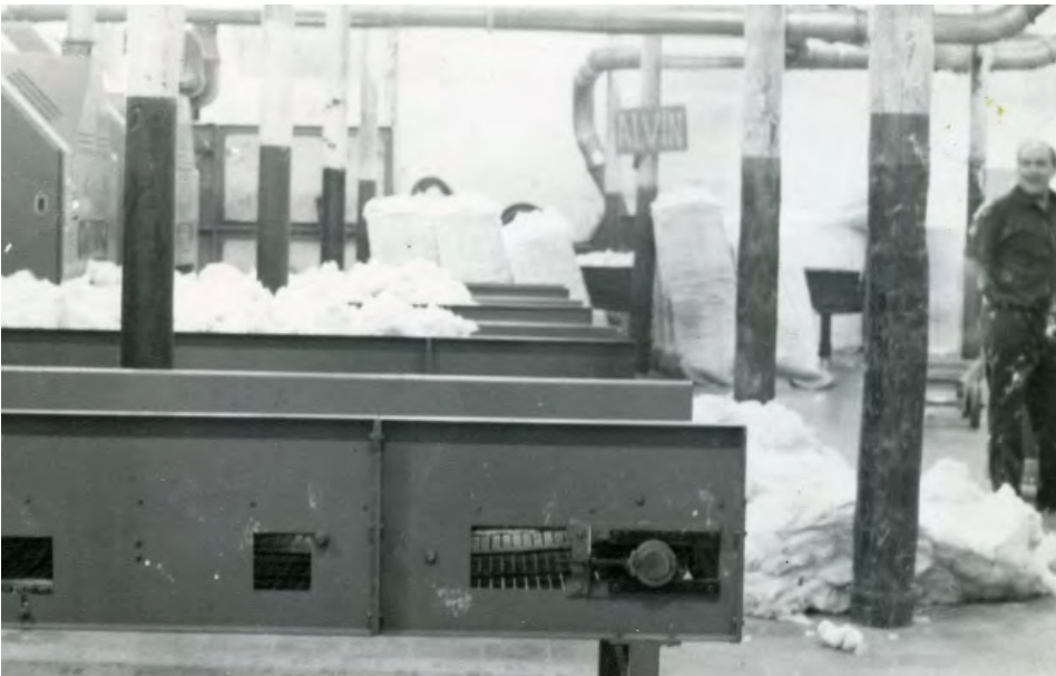
Caixa per on es carregava el cotó per al batan. A la imatge es pot apreciar la quantitat de borra que hi havia a les fàbriques tèxtils. Segona meitat del segle XX.
