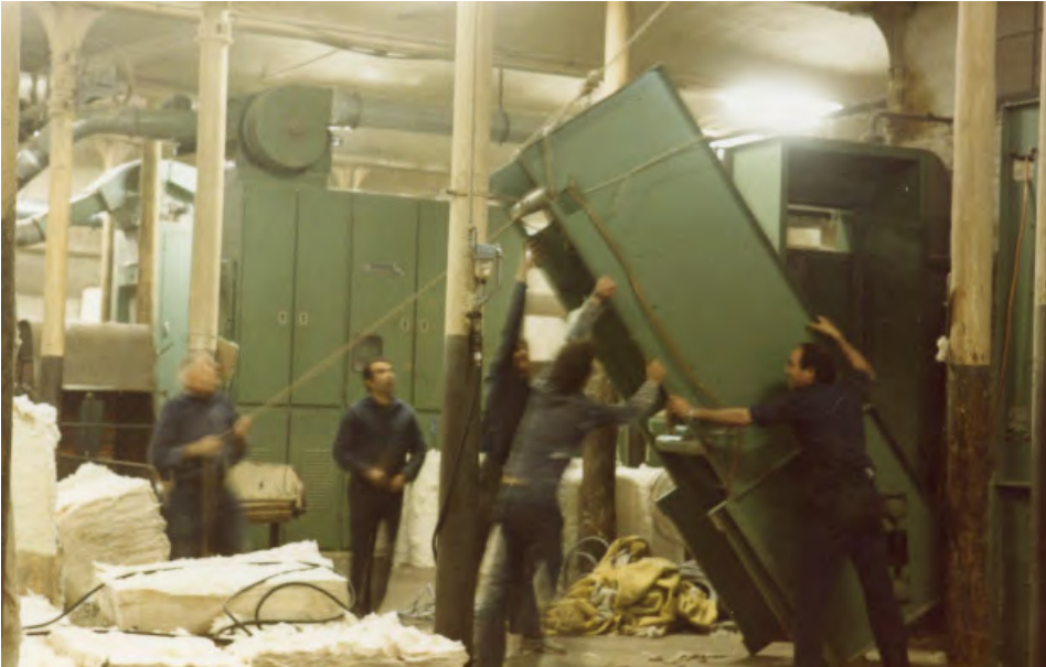
Mecànics de la fàbrica Nova desmuntant un batan. Dècada de 1980. Autor: Josep Maria Musachs. Procedència: Família Musachs.
