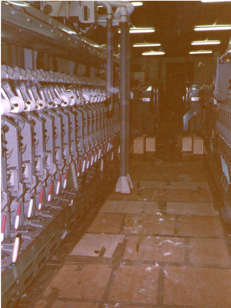
Aspirador de borra de la secció dels cabdellers (ovilleros) de la fàbrica Vella. A la imatge també es pot veure el terra cobert de cartrons per no relliscar amb la cera que desprenia el fil. Dècada de 1990. Procedència: Mercè Soler.
