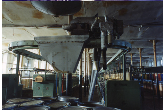
Sala de metxeres d'Hilaturas Marquet, situada al primer pis de la nau a la dècada de 1990. En primer terme i penjat del sostre hi ha un aspirador de borra, també anomenat avió. En aquest cas les metxeres són de la marca Platt Saco Lowell de Manlleu. Autor: Josep Maria Musachs. Procedència: Família Musachs
