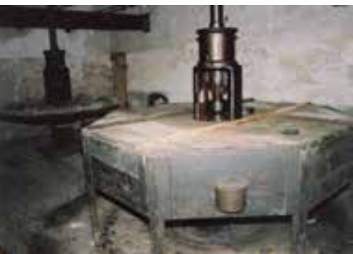
Turbines velles amb parament de fusta. Fons Cal Pastor.
